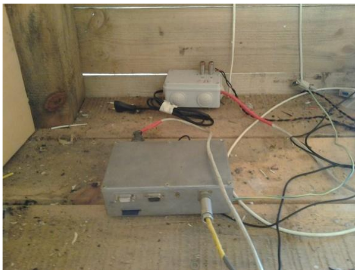
Рисунок 4 - Установка индукционного магнитометра на основе датчика ИНТ-1 на магнитной станции «Байгазан»: схема (а), заглубление датчиков в землю (б), регистрационный блок (в).
