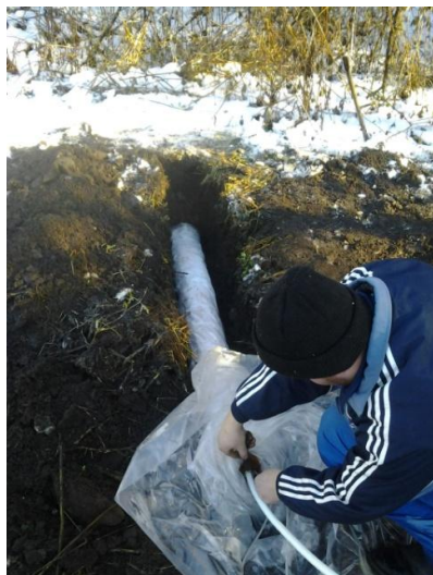
Рисунок 4 - Установка индукционного магнитометра на основе датчика ИНТ-1 на магнитной станции «Байгазан»: схема (а), заглубление датчиков в землю (б), регистрационный блок (в).
